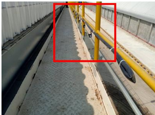
รูปที่ 43 สายพานลำเลียงกากตะกอนหมักทรงแบบปิดครอบ และหัวสเปรย์น้ำ บริเวณพื้นที่การขนถ่ายลงรถบรรทุก
